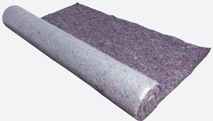
Malerabdeckvlies aus Textilfasern, 250 g/m<sup>2</sup>, mit rutschhemmender Oberseite. Einseitig mit 15 µm Folie kaschiert. Easypaint ist wiederverwendbar. Abdeckung von zu schützenden Untergründen/Bodenbelägen z.B. bei Maler- und Putzarbeiten, zum Schutz frisch verlegter Böden, Renovierungsarbeiten.
